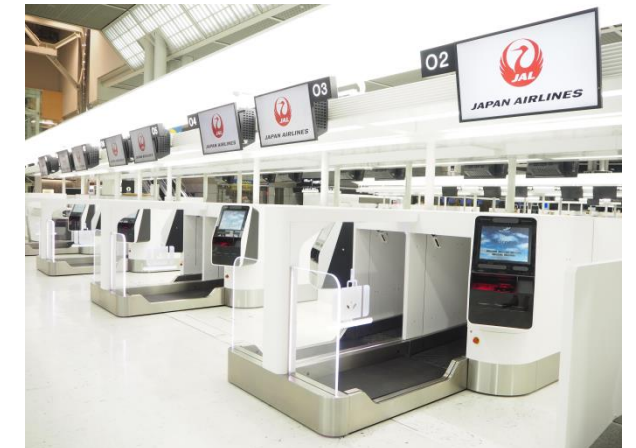
成田空港(国際線)における自動手荷物預け機
