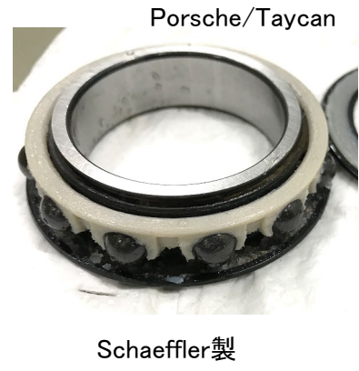
(a) 絶縁ベアリング (セラミックボール使用)
