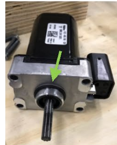
(7) トランスミッションオイルセンサのシール (低温フッ素ゴム)
