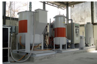
タイ・ナコンナヨク県に設置した高効率小型バイオガスプラント
